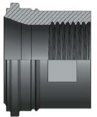
Bundstutzen mit Rohrgewinde innen (Gasrohrgewinde zyl. nach ISO 228-1) Typ LMA3
